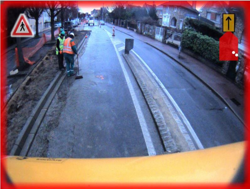
*Exemple de détection de piétons : cadre rouge et icône piéton. Dans le coin supérieur droit, une vue radar présente la zone de détection (en rouge) et la position approximative des piétons détectés (points blancs).*
