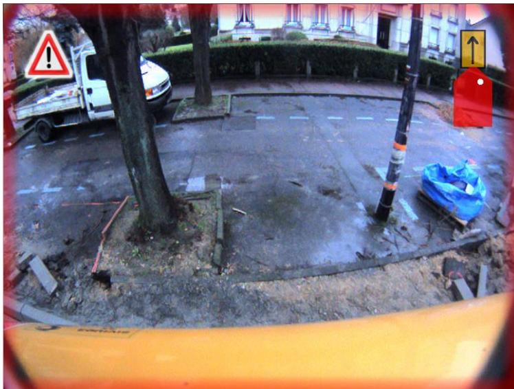
*Exemple de détection d'obstacles : cadre rouge et icône d'avertissement. Dans le coin supérieur droit, une vue radar présente la zone de détection (en rouge) et la position approximative de l'obstacle détecté (point blanc).*
